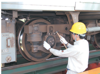
▶車両の走行距離によって検査項目が決められている。検査に使う工具は100種類以上あるそう
